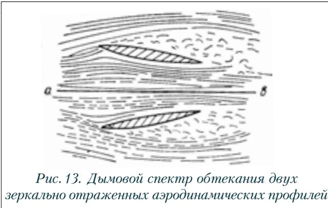
Рис. 13. Дымовой спектр обтекания двух зеркально отраженных аэродинамических профилей
