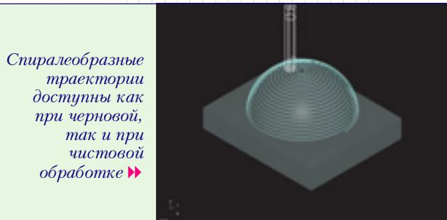
Сpiraleобразные траектории доступны как при черновой, так и при чистовой обработке»
