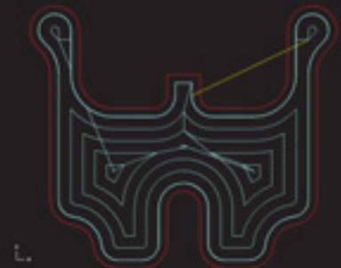
«Без явных функций ВСО, хотя фреза удаляет материал вдоль стенок, что является предпочтительным принципом удаления материала при ВСО»
