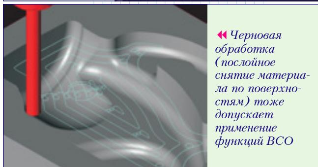
«Черновая обработка (послойное снятие материала по поверхности) тоже допускает применение функций ВСО»
