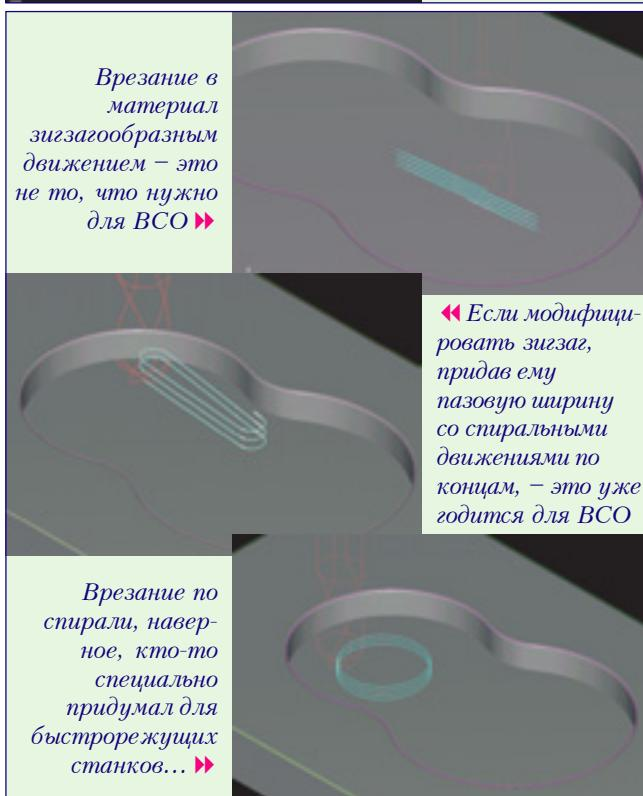
В данном примере показана выборка кармана. Использована схема удаления материала вдоль стенки
