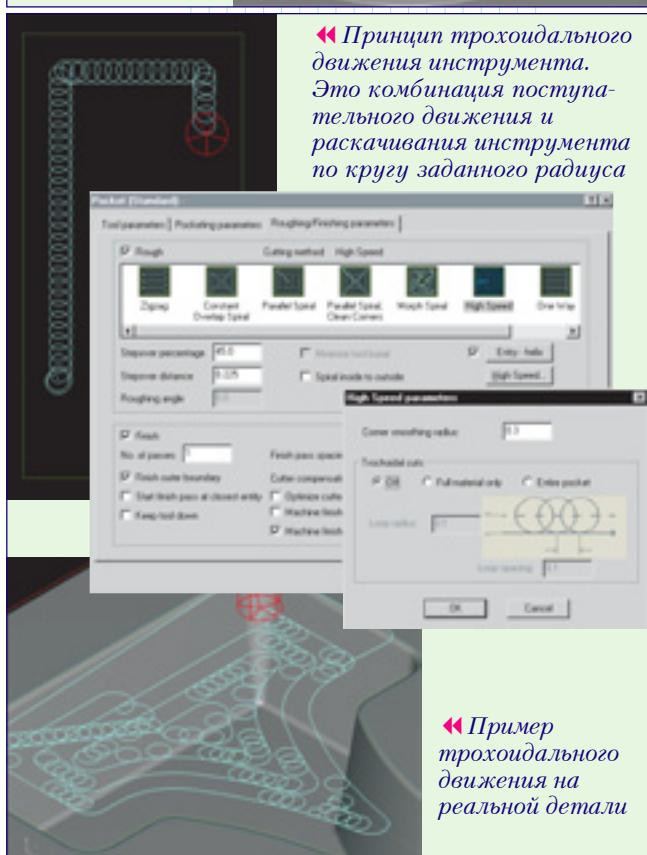
«Принцип трохоидального движения инструмента. Это комбинация поступательного движения и раскачивания инструмента по кругу заданного радиуса»
