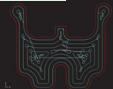
Обработка контура путем опускания инструмента спиральным движением»
