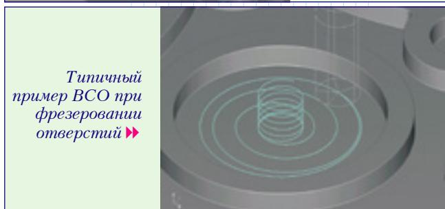
Типичный пример ВСО при фрезеровании отверстий»
