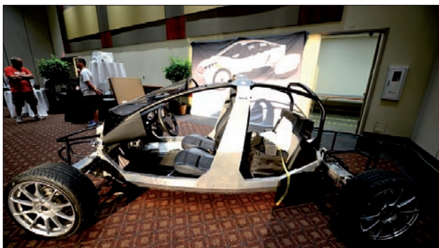
Четырехместный электромобиль Very Light Car (VLC), созданный командой Edison2
