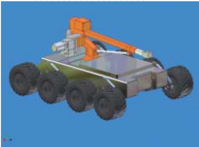
Рис. 2. Транспортное средство МР с изменяемой геометрией колесного движителя
