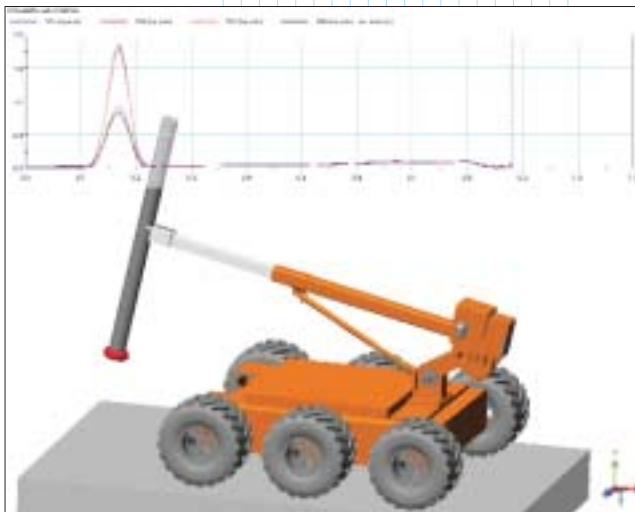
Рис. 10. Моделирование поведения МР при выстреле разрушителя ВУ
