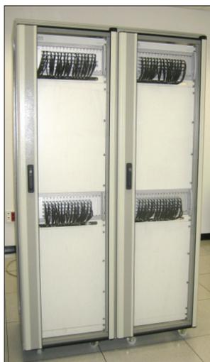
Рис. 1. 700-канальная система компании LMS для сбора данных при наземных частотных испытаниях
