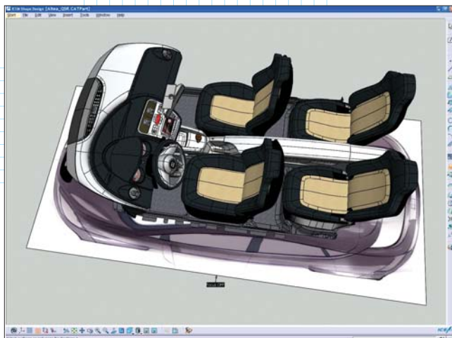
ICEM Shape Design дает возможность переводить 2D-эскизы и картинки в 3D-среду, делая их основой для создания ассоциативных каркасных моделей. (Иллюстрация любезно предоставлена компанией SEAT)
