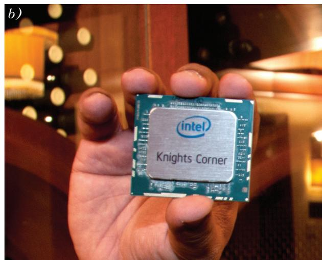
*Рис. 1. Суперкомпьютер ASCI Red (a) и многоядерный чип Knights Corner (b), впервые в мире преодолевшие рубеж 1 TFLOPS в 1997 и 2011 годах соответственно*
