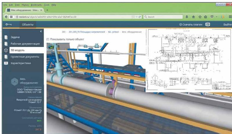
Рис. 2. Пример реализации доступа к данным (характеристика насоса) посредством 3D-модели и 2D-чертежа
