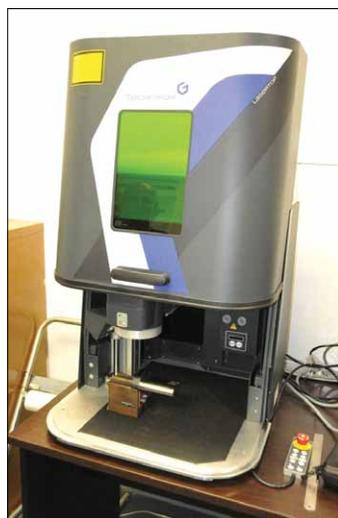
*Новый гравировальный лазер Technifor служит для маркировки и трассировки*
