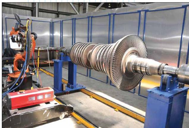
*На производстве MAN Diesel & Turbo South Africa освоили технологию восстановления турбин на основе лазерной наплавки*
