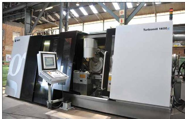
*Новый станок Liechti Turbomill позволяет обрабатывать лопасти длиной до 1350 мм, что является большим достижением. Для сравнения: длина лопастей турбин АЭС Koeberg в Western Cape – только 1280 мм*
