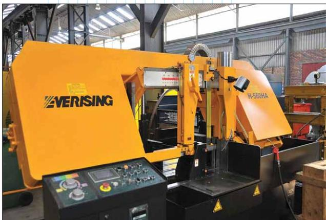
*Размер используемых заготовок определяется возможностями ленточной пилы колонного типа Everising-H560 HA, поставляемой компанией First Cut*
