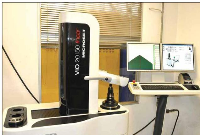
*Недавно в цехе MAN Diesel & Turbo South Africa было установлено устройство предварительной наладки инструментов DMG, которое поставила компания Retecon Machine Tools*
