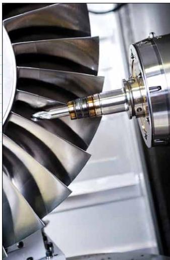
*Обработка лопастей для авиационных двигателей и турбин электростанций*
