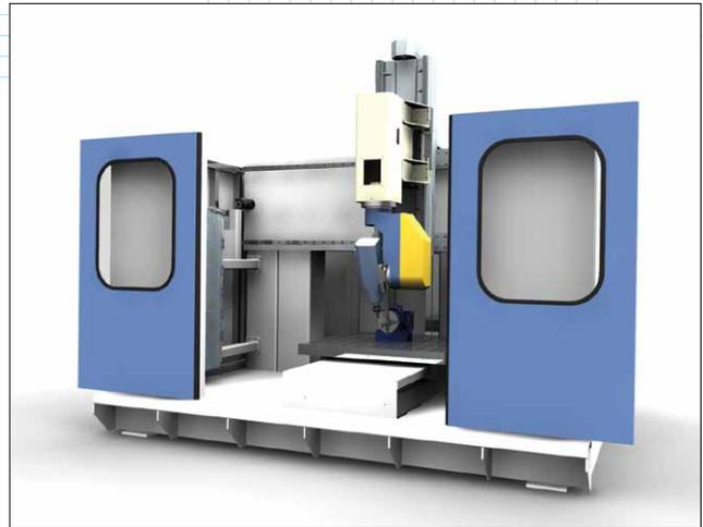
*Виртуальные модели позволяют выполнять отладку мехатронных узлов, в результате чего объемы натуральных испытаний станков сокращаются*
