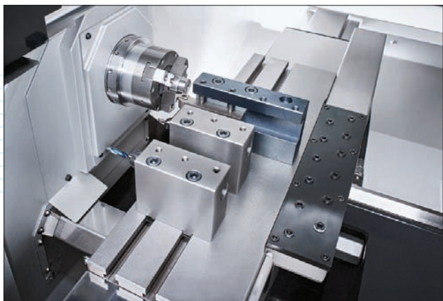
Благодаря применению держателей с линейным перемещением, а также своей высокой стабильности и жесткости, модель G07 прекрасно подходит для обработки материалов высокой твердости
