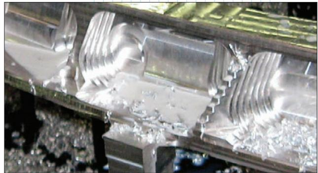
Рис. 2. Следы, оставляемые инструментом на обрабатываемой поверхности
