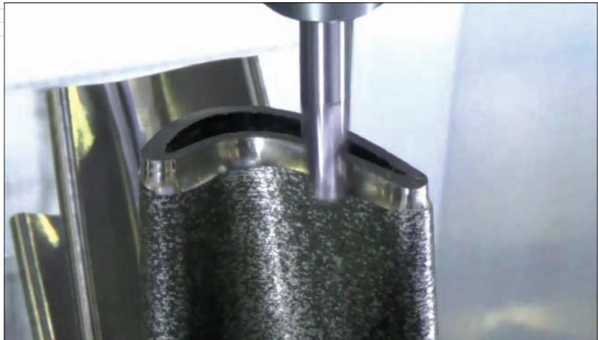
*На одном и том же станке с ЧПУ выполняется и добавление, и снятие материала. Благодаря этому детали сложной формы изготавливаются с максимально возможной точностью*
