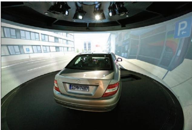
*Ячейка стенда исследования маневренности оборудована экраном с круговым обзором. Шесть её ног управляются мощными электродвигателями, а возможность перемещения по 12-метровому рельсу обеспечивает имитацию перестроения с одной полосы на другую*
