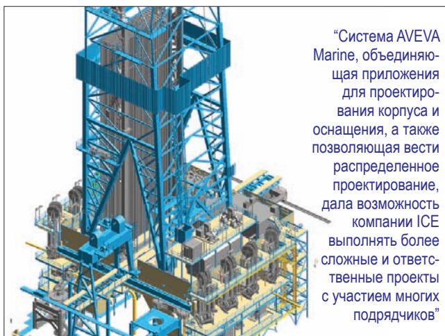
Модель буровой установки, выполненная средствами AVEVA Marine (изображение является собственностью ICE)
