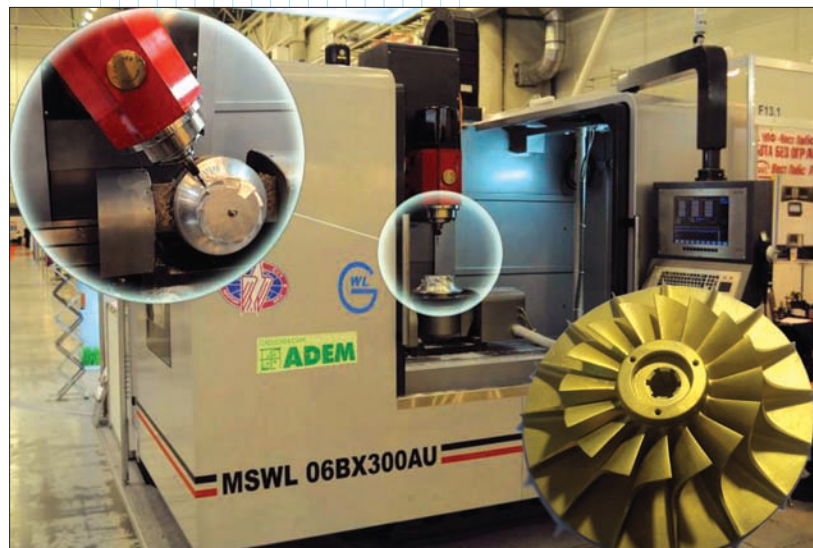
Рис. 2. Четырехкоординатное плунжерное фрезерование моноколеса (титан)
