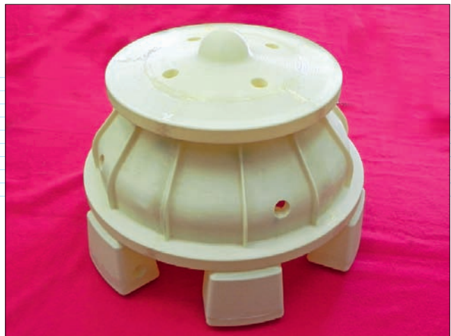
Рис. 7. Модель модельного блока, изготовленная из 24-х частей
