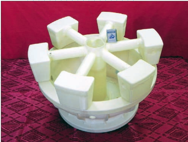
Рис. 7. Модель модельного блока, изготовленная из 24-х частей
