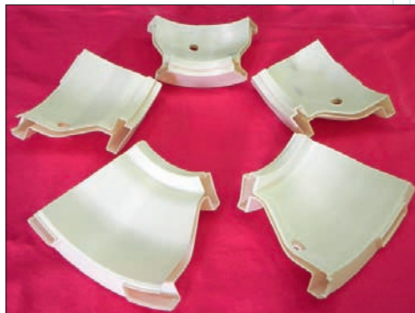
Рис. 5. Модель корпуса, изготовленная из пяти частей
