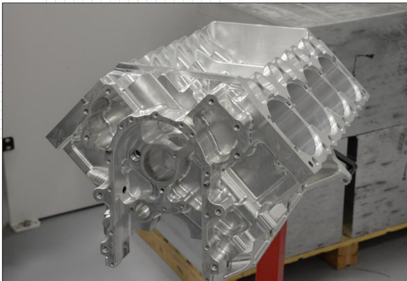
*Блок цилиндров двигателя, изготовленный на заводе Don Schumacher Racing. Фрезерование алюминиевой заготовки весом 360 кг осуществлялось с помощью высокоскоростных динамических траекторий Mastercam Dynamic Motion, начиная с траектории Opti-Rough для черновой обработки сложной геометрии. Вес готовой детали составил 64 кг*
