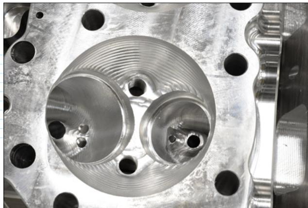
*Обработка блока двигателя на станке Okuma MU6300V. В качестве заготовки используется блок крайслеровского двигателя Hemi*
