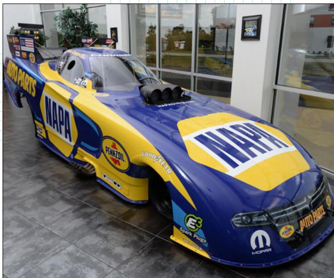
*Машины класса Funny Car, предназначенные для драг-рейсинга, имеют переднемоторную конструкцию и откидывающийся карбоновый кузов. Одна из самых больших проблем, с которыми сталкиваются технологи – необходимость изготовить детали одновременно легкие и достаточно прочные, способные выдерживать жесткие условия скоростных соревнований, включая перегрев двигателя и столкновения. (Иллюстрации предоставлены компанией CNC Software)*
