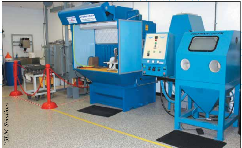
Рис. 10. Зона постобработки с печью, столом с вытяжкой и дробеструйной камерой
