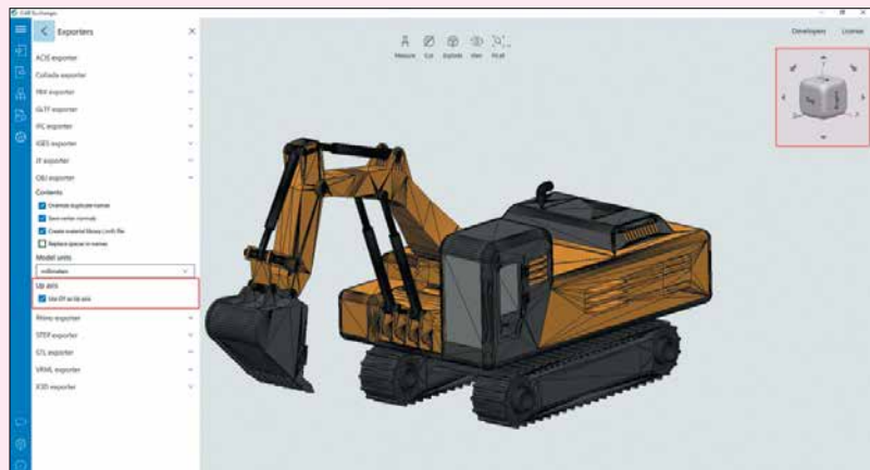
Использование оси Y в качестве вертикальной для форматов Collada , FBX , GLTF , OBJ
