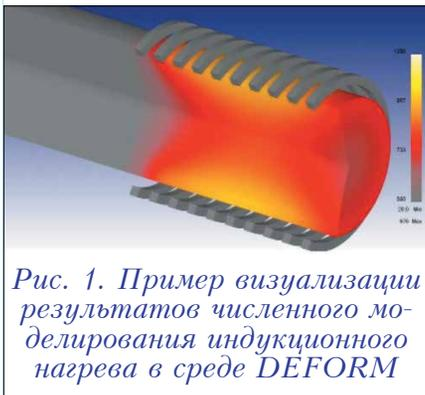
*Рис. 1. Пример визуализации результатов численного моделирования индукционного нагрева в среде DEFORM*
