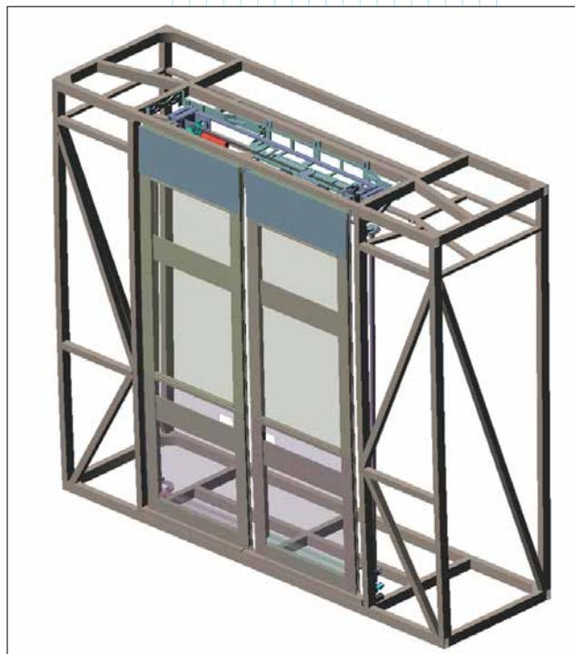
Рис. 6. Расчетная модель двери в среде *Adams*
