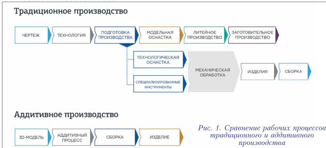
Рис. 1. Сравнение рабочих процессов традиционного и аддитивного производства
