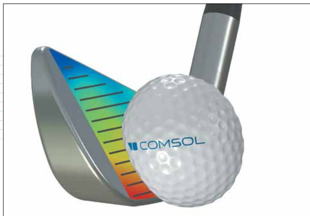
Моделирование динамического контактного взаимодействия при ударе металлической клюшкой по мячу для гольфа
