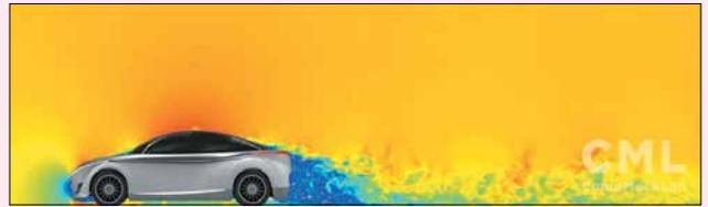
Платформа виртуального проектирования будет использоваться в проектах *CompMechLab* для автоматизации процесса генерации оптимальных с точки зрения аэродинамики поверхностей (стилей) автомобилей и для оптимизации имеющихся стилей с целью уменьшения коэффициента аэродинамического сопротивления автомобилей и, как следствие, улучшения их потребительских свойств.
