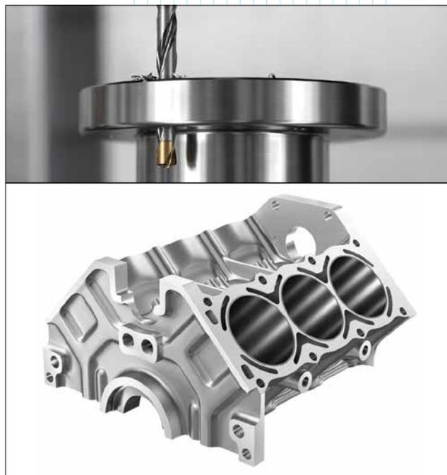
*Сверло CoroDrill 860-GM отлично показало себя у автопроизводителей при сверлении отверстий в блоках цилиндров двигателей*
