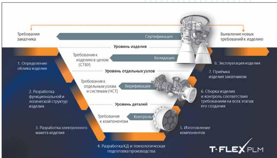
Рис. 1. T-FLEX PLM: разработка изделия на основе требований
