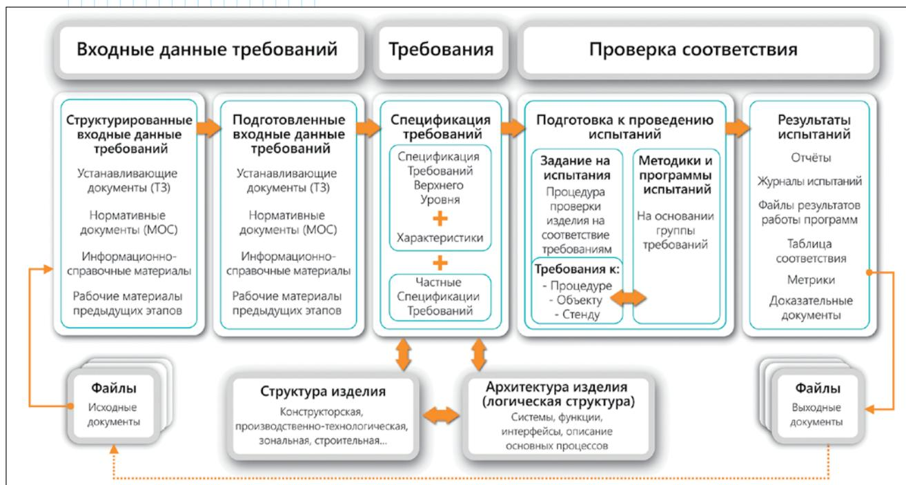
Рис. 2. T-FLEX PLM: модель данных в системе управления требованиями
