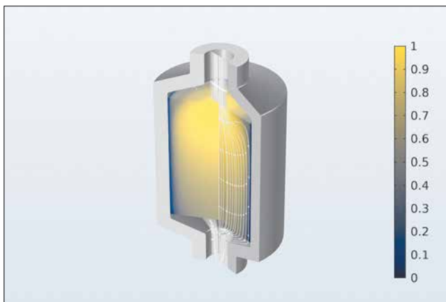
Модель теплового аккумулятора, в которой учитывается изменение фазового состояния и используется неравновесное приближение
