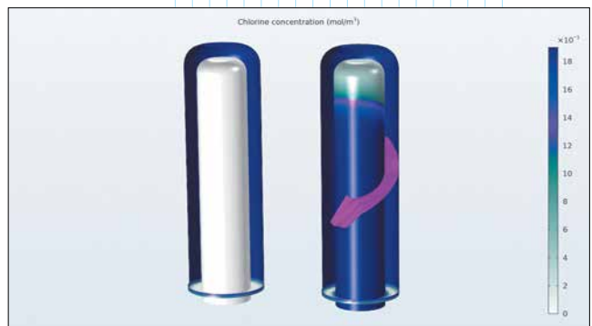
Результаты моделирования керамического водяного фильтра с пористым угольным фильтрующим элементом
