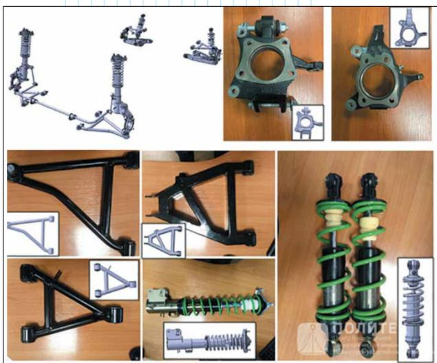
Рис. 3. Детали подвески электромобиля
