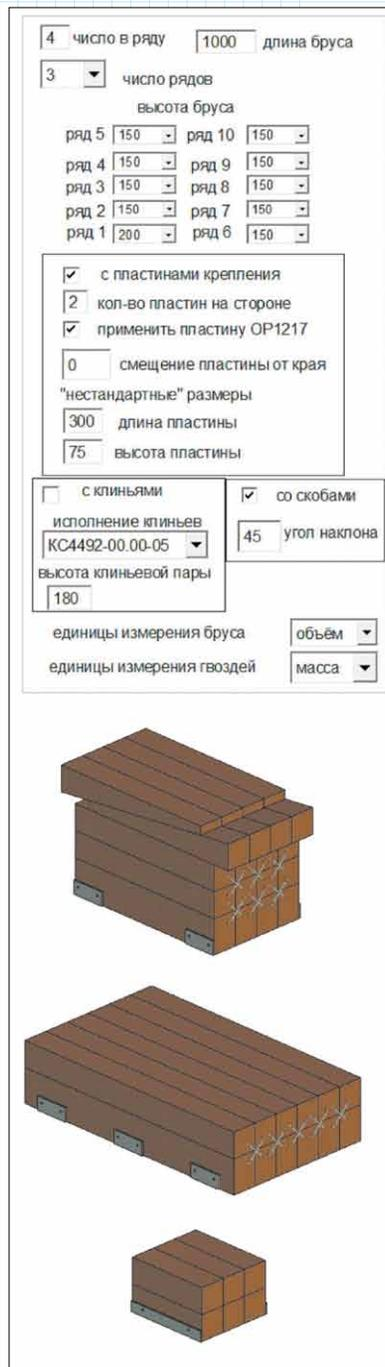
Рис. 2. Диалоговое окно для ввода параметров и варианты конфигурации модели брусовой подушки
