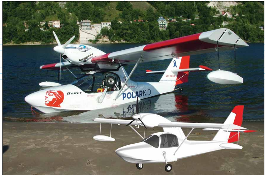
Рис. 2. BOREY полностью спроектирован в среде КОМПАС-3D, включая теоретический чертеж и обводы корпуса, по которым на станках с ЧПУ и 3D-принтерах были изготовлены мастер-модели для получения рабочих матриц
