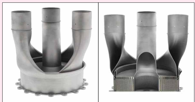
Пример изготовленного методом 3D-печати теплообменника, расчет которого был произведен в среде Altair Flow Simulator
