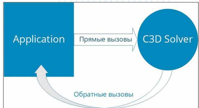
Рис. 9. Обратные вызовы в C3D Solver 2019
