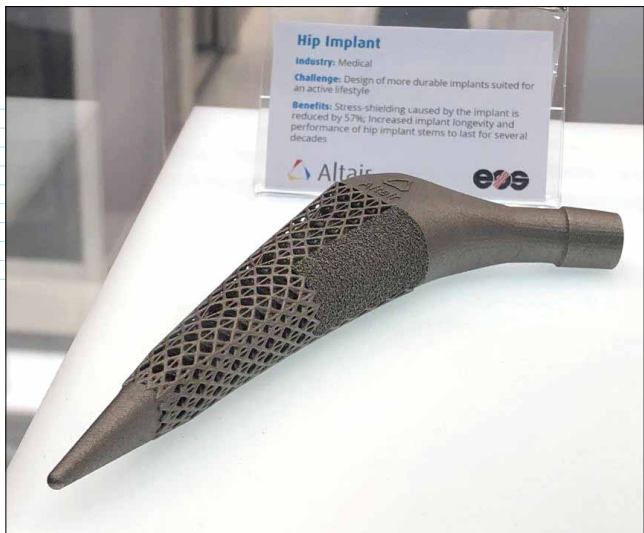
Ножка эндопротеза тазобедренного сустава должна быть достаточно прочной, чтобы долгое время выдерживать механические нагрузки, соответствующие стилю жизни пациента, но не слишком жесткой, чтобы не создавать эффект экранирования напряжений. Команда инженеров Altair оптимизировала титановый имплант, используя сочетание возможностей CAE, оптимизации топологии и 3D-металлопечати. Этот имплант был продемонстрирован на выставке Formnext 2018
