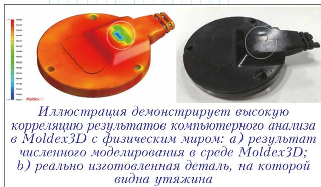
*Иллюстрация демонстрирует высокую корреляцию результатов компьютерного анализа в Moldex3D с физическим миром: а) результат численного моделирования в среде Moldex3D; б) реально изготовленная деталь, на которой видна утяжина*
