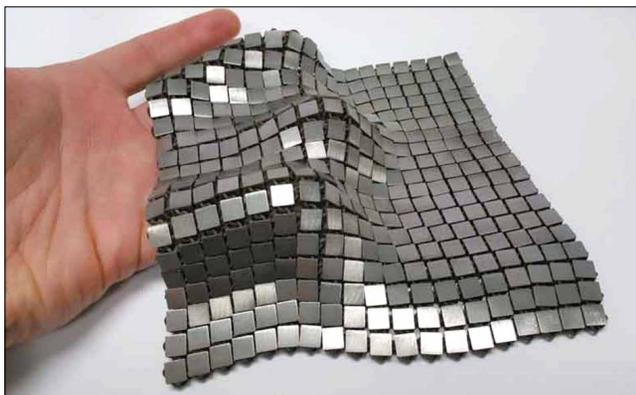
*Рис. 3. Это металлическое “пространственное полотно” было создано с помощью методов 3D-печати, которые позволили придать разные свойства каждой стороне материала.
