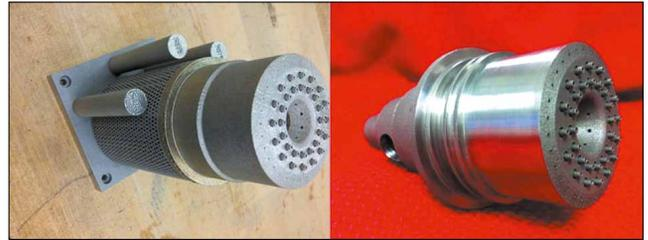
Рис. 1. Слева показан инжектор сразу после извлечения из установки селективного лазерного плавления металлического порошка (SLM), справа – он же после завершения операции. (Фото: NASA/MSFC)
