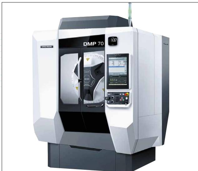
Благодаря небольшой установочной площади (4,2 м<sup>2</sup>), новый станок DMP 70 будет отличным компактным решением для отраслей с высокими требованиями к качеству поверхностей
