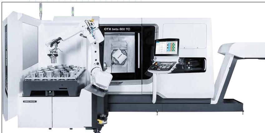
*Robo2Go – гибкая система загрузки-выгрузки инструмента для токарных центров*
