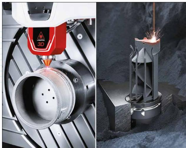
*Линейка оборудования DMG MORI для аддитивного производства позволяет реализовать четыре полные технологические цепочки с направлением подаваемого через сопло порошка и с селективным плавлением слоя в порошковой камере*
