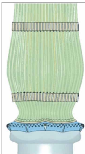
Торец ТВС, деформированный в результате аварийного падения
