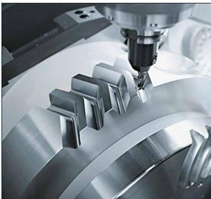
серия станков **NMV** компании **DMG MORI** – это вертикальные обрабатывающие центры, в создании которых были использованы новейшие технологии этой компании: **DDM** (*Direct Drive Motor*), **DCG** (*Driven at the Center of Gravity*) и **ORC** (*Octagonal Ram Construction*).
