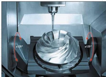
Хотя в станках этой серии используется наклоняемый стол, они могут справиться с удивительно крупными заготовками. Так, самая большая модель позволяет обрабатывать заготовки весом до 6 тонн, обеспечивая следующие перемещения по осям X-Y-Z: 1336 мм × 1250 мм × 900 мм. При необходимости станок можно оснастить еще более быстрым столом, который позволяет выполнять вертикальное точение и 5-осевую фрезерную обработку.
