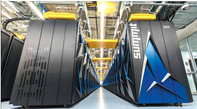
*Суперкомпьютер Summit (США), ставший лидером рейтинга Top500 в июне 2018 года, смонтирован из 4 356 вычислительных серверов, построенных на базе центральных процессоров IBM POWER9 и графических процессоров NVIDIA Tesla V100. Реальное быстродействие системы Summit (122.3 Pflops) впервые в мире преодолело рубеж в 100 Pflops*
