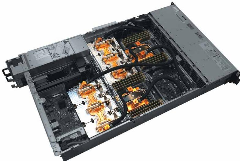
*Каждый из 4 356 вычислительных серверов, из которых построена система Summit, состоит из двух 22-ядерных центральных процессоров IBM POWER9 (тактовая частота 3.1 GHz) и шести 80-ядерных графических процессоров NVIDIA Tesla V100*
