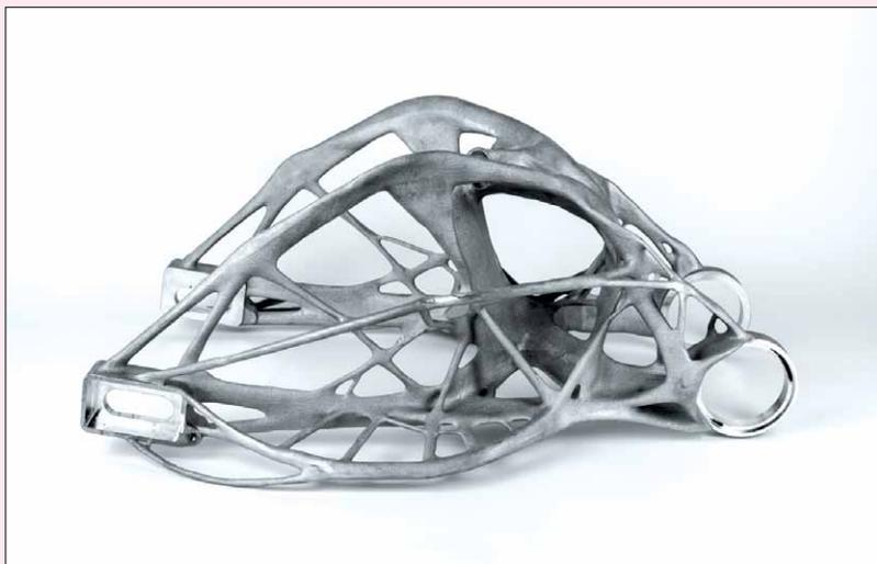
Конструкция маятника мотоцикла компании Lightning Motorcycles была усовершенствована с помощью функционала генеративного дизайна
