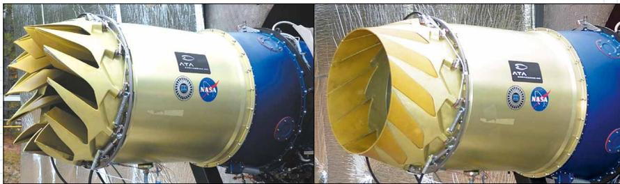
Рис. 1. Установка ДВТ на двигатель FJ44-4
