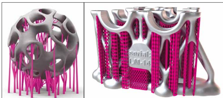
Рис. 5. Модели деталей с поддержками
