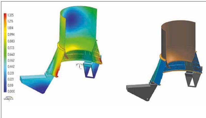
**Orbital ATK проектирует усовершенствованные ускорители, которые будут иметь большую тягу, и будут использоваться в последующих миссиях Space Launch System. Компания применяет NX CAE для кинематического анализа и прочностных расчетов в интегрированном процессе разработки, что дает уверенность в том, что большие ускорители не повредят конструкции на пусковой площадке.**
