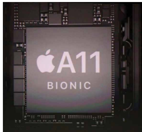
Рис. 8. Apple A11 Bionic – 64-разрядный ARMv8-A процессор (4.3 млрд. транзисторов) с шестью ядрами CPU (тактовая частота до 2.39 GHz), тремя ядрами GPU и NPU (нейронный процессор с производительностью до 600 Gflops как ускоритель алгоритмов ИИ), изготовленный в соответствии с 10-нм технологическим процессом FinFET
