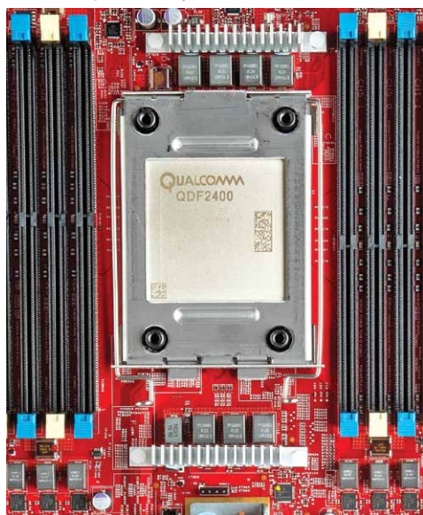
Рис. 11. Qualcomm Centriq 2400 – 64-разрядный 48-ядерный серверный ARM-процессор (тактовая частота до 2.6 GHz), который первым в мире был изготовлен в соответствии с 10-нм технологическим процессом (FinFET)
