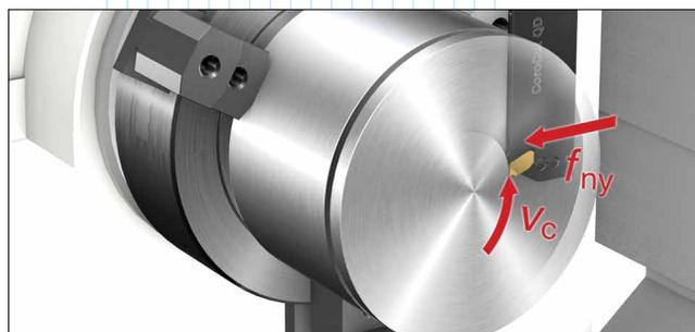
инструмента, которое требуется при установке каждого нового лезвия. При этом также обеспечивается правильное положение относительно высоты центров.
