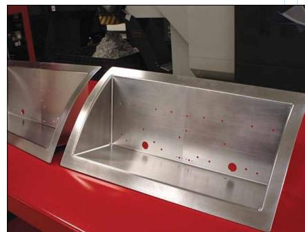
Удаление большого количества материала характерно для обработки авиакосмических и автомобильных деталей. Каждая алюминиевая заготовка, из которой изготовлен корпус осветителя шасси, весила свыше 90 кг. Более половины этого материала было удалено методом черновой 3-осевой обработки
