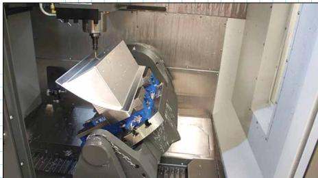
Большая часть чистовой обработки корпуса осветителя шасси выполнялась на новейшем 5-осевом обрабатывающем центре. Но на данной фотографии запечатлен третий установ детали: на более старом 5-осевом станке подчищаются те зоны, которые нельзя было обработать за второй установ. Хотя эту операцию можно было бы выполнить и на 3-осевом оборудовании, на 5-осевом станке проще наклонить деталь для съема оставшегося металла
