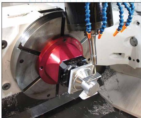
Существенными пунктами “предполетной подготовки” является наличие большого 5-осевого станка, приспособлений типа “ласточкин хвост” для фиксации детали, специальных термопатронов для зажима инструмента, высокопроизводительных режущих инструментов и формируемой современной CAM-системой *Mastercam* траекторий
