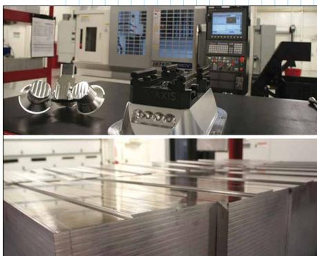
Для 5-осевых операций используется крепежное приспособление компании *5th Axis*, в котором детали удерживаются с помощью двухмиллиметровых выступов типа “ласточкин хвост”, которые на заготовках делаются заранее на 3-осевом вертикальном станке *Okuma GENOS M560-V* (виден на заднем плане)
