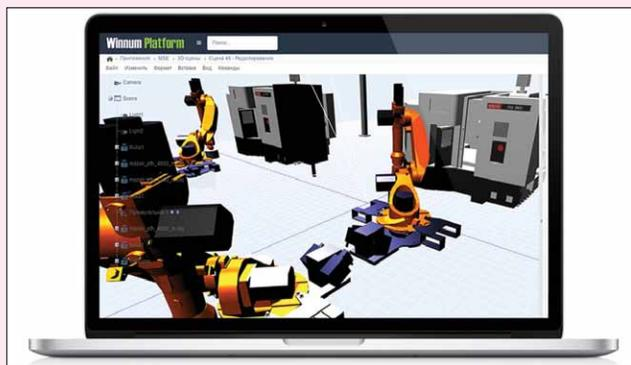
различных САПР. *Winum* поддерживает загрузку 3D-моделей в нейтральных форматах, таких как *STL*, *VRML* и *OBJ*; для *Blender* и *Collada* реализована прямая загрузка. Наличие готовых 3D-библиотек оборудования, роботов, датчиков и других геометрических объектов еще больше ускоряет и упрощает процесс создания ЦД.
