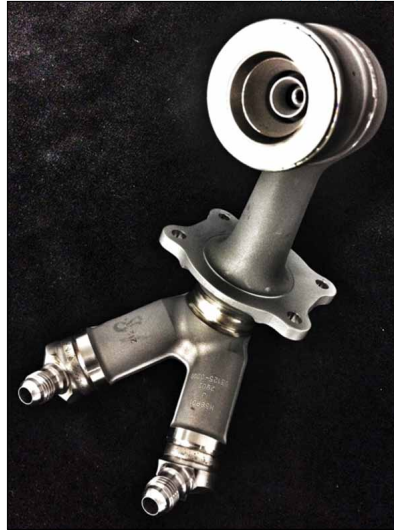
У двигателя LEAP будет 19 топливных форсунок, напечатанных на 3D-принтере, и множество других 3D-печатных деталей – например, корпус сенсора T25, который обеспечивает измерение давления и температуры для управляющей системы двигателя. (Иллюстрация любезно предоставлена компанией CFM International)
