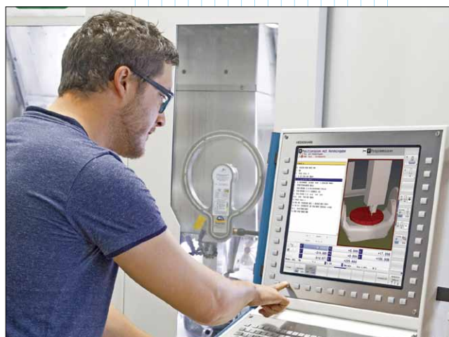
Функция DCM в режиме реального времени предсчитывает перемещения в рабочей зоне станка и предотвращает столкновения
